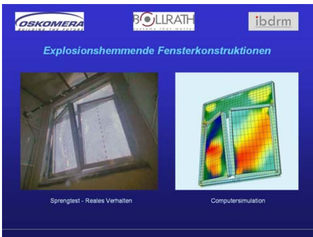
Vergleich Sprengtest – Computersimulation
